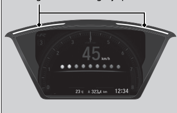
Achtergrondverlichting bij opschakelen
